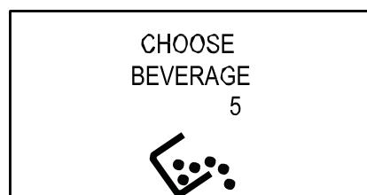
Ukoliko se prazne kapsule ne uklone iz fijoke za prazne kapsule, nakon nekoliko napravljenih kafa aparata će se zaustaviti sa radom. Displej će prikazati:
