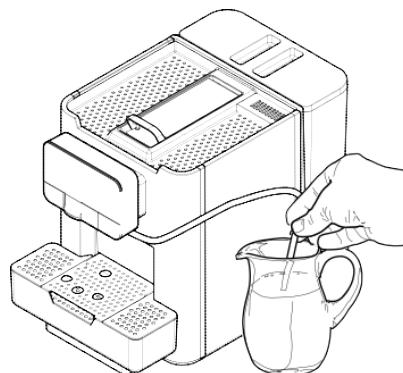
Proverite da je ispust za pravljenje napitaka u gornjem položaju. Postavite posudu ispod ispusta za (mleko i kafu).
